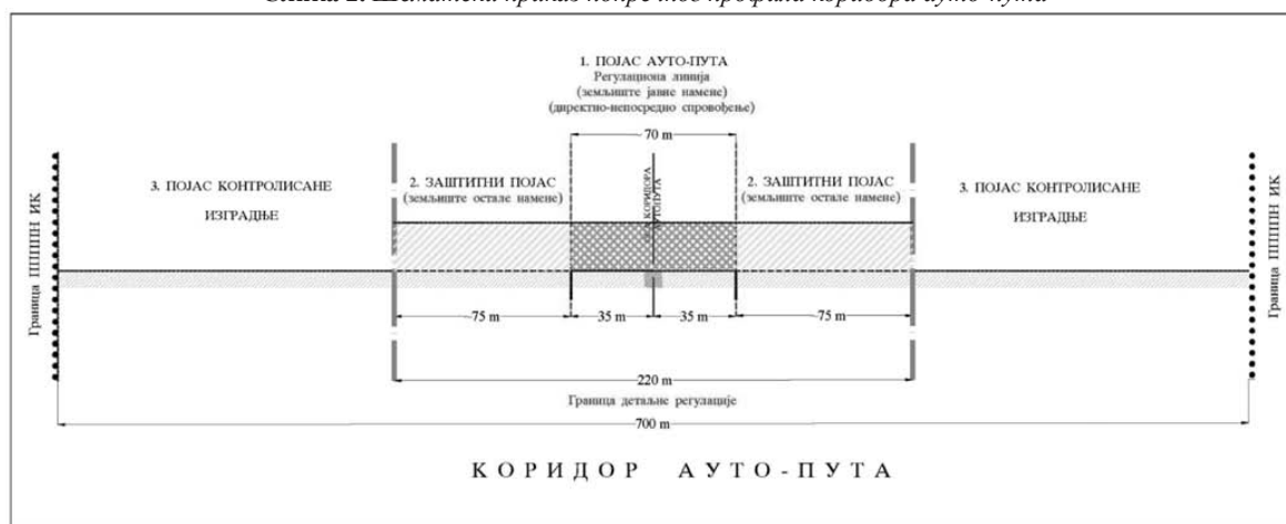
Слика 2. Шематски приказ попречног профила коридора ауто-пута
