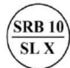
Слика 3. Жиг за накнадну уградњу граничника брзине, где „x” представља бројчану ознаку радионице
