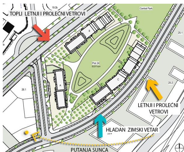
Слика бр. 29 – Шема утицаја ветра (блок 24)
