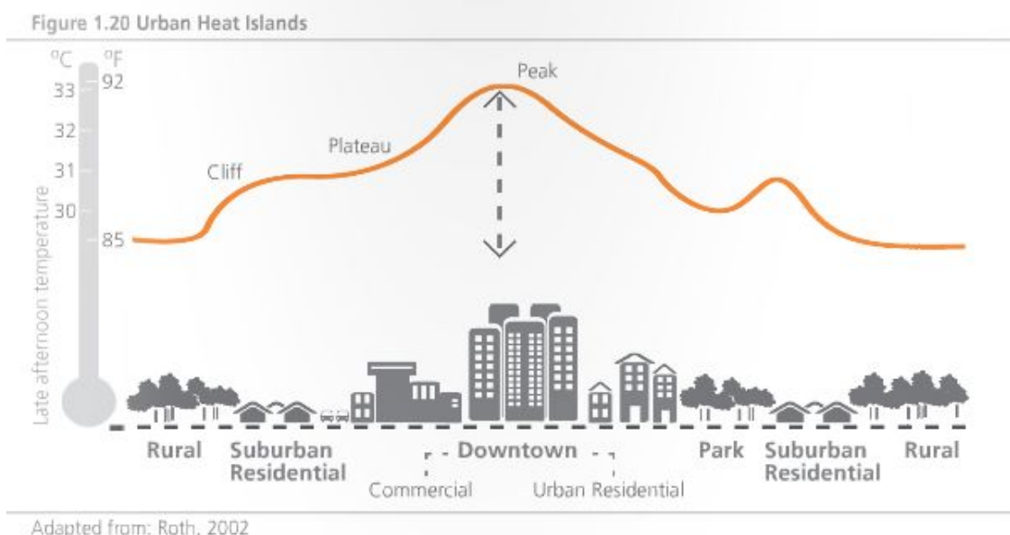
Слика бр. 30 – Феномен топлотног острва у градовима. Утицај густине и висине објекта на температуру у околини
