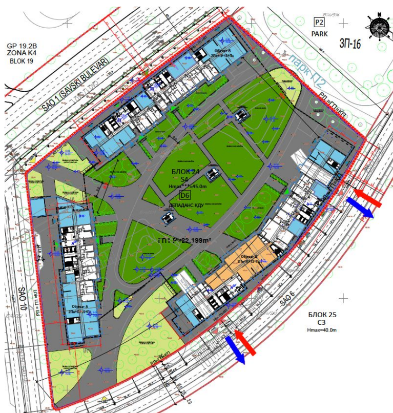
Слика бр. 21 – Положаји колских улаза и излаза са ГП1, блок 24
