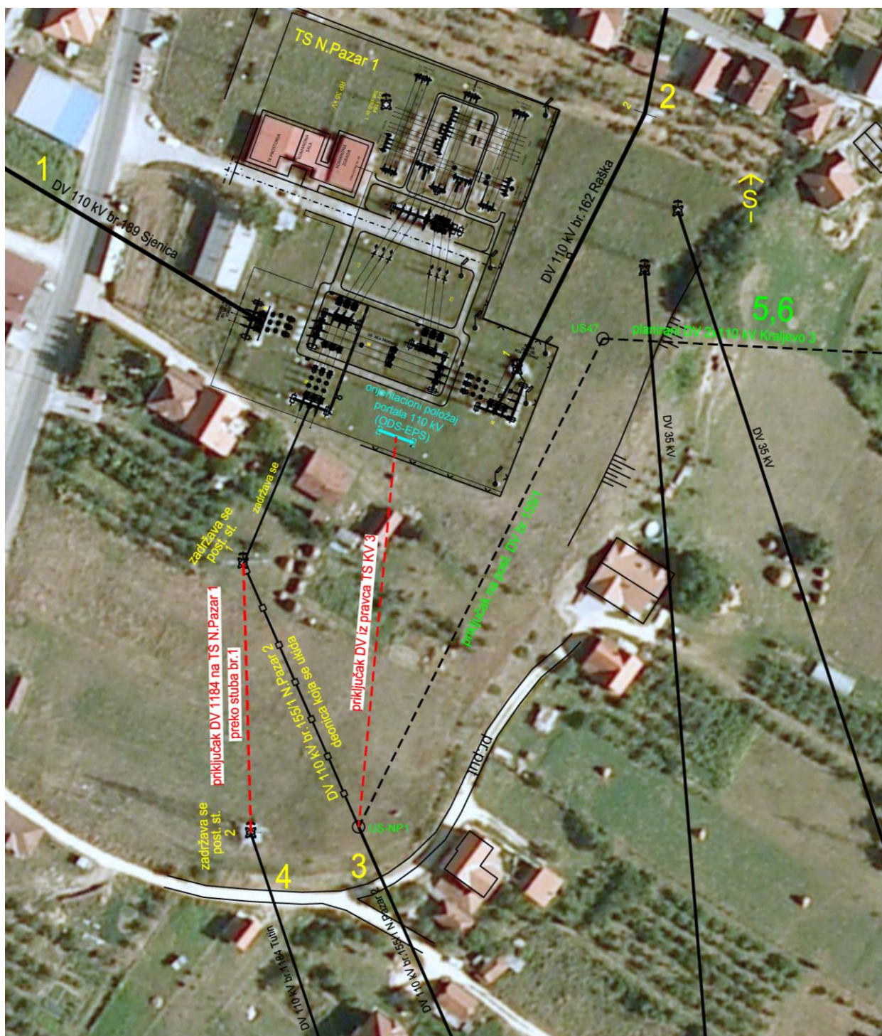
Slika 2 – Rasplet DV kod TS Novi Pazar 1 u prvoj fazi, pre rekonstrukcije TS Novi Pazar 1
