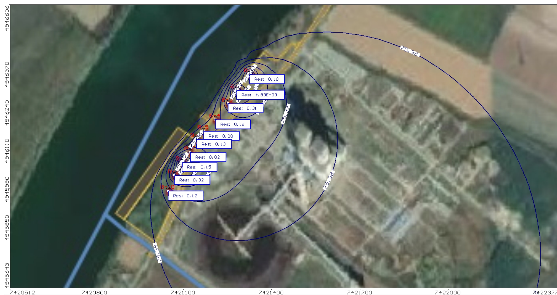
Slika 15. Karta hidroizohipsi sa rezidualnom razlikom za stacionarne uslove strujanja, za šire područje izvorišta TENT B
